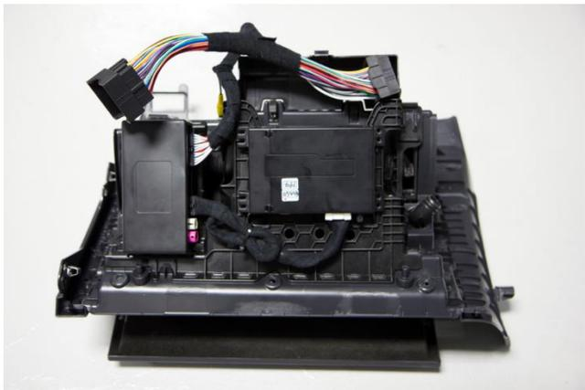
5. Posizionare il navigatore ed il modulo di controllo sul lato superiore del vano portaoggetti
