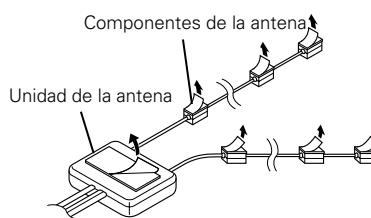
**2** Retire las tiras protectoras de los componentes de la antena y de la parte posterior de la unidad de antena.
