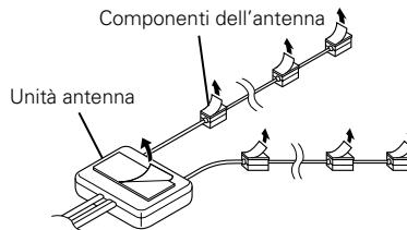
**2** Rimovete le strisce di protezione dai componenti dell'antenna e dal retro dell'unità antenna stessa.
