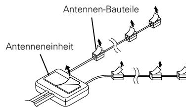
**2** Entfernen Sie die Schutzstreifen von den Antennen-Bauteilen und der Rückseite der Antenneneinheit.
