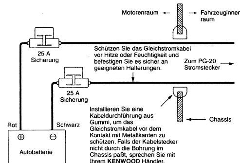
Zum Ersatz einer durchgebrannten Sicherung heben Sie den Deckel der Sicherungshalterung an und ersetzen die Sicherung durch eine neue mit dem gleichen Nennwert. Dann drücken Sie zum Verschließen den Sicherungsdeckel fest an.
