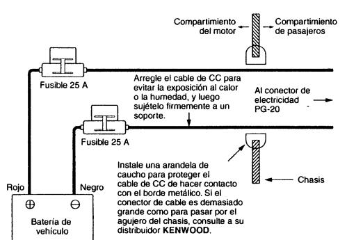
Para cambiar un fusible quemado, levante la tapa del portafusible, reemplace el fusible con uno de la misma clasificación, y luego oprima la tapa del fusible para cerrarla.
