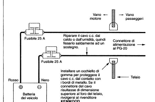
Per sostituire un fusibile bruciato, sollevare la copertura del portafusibili, inserire un fusibile della stessa potenza nominale di quello bruciato quindi richiudere la copertura premendola con decisione in posizione.
