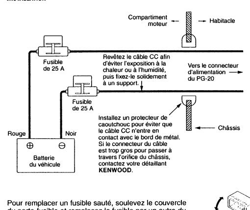
Pour remplacer un fusible sauté, soulevez le couvercle du porte-fusible et remplacez le fusible par un autre du même calibre, puis appuyez fermement sur le couvercle pour bien le bloquer en place.
