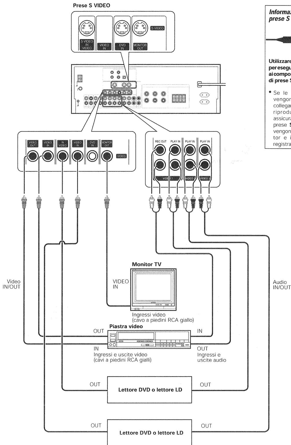
È necessario collegare un componente video dotato di uscite audio digitali alle prese VIDEO 2.
