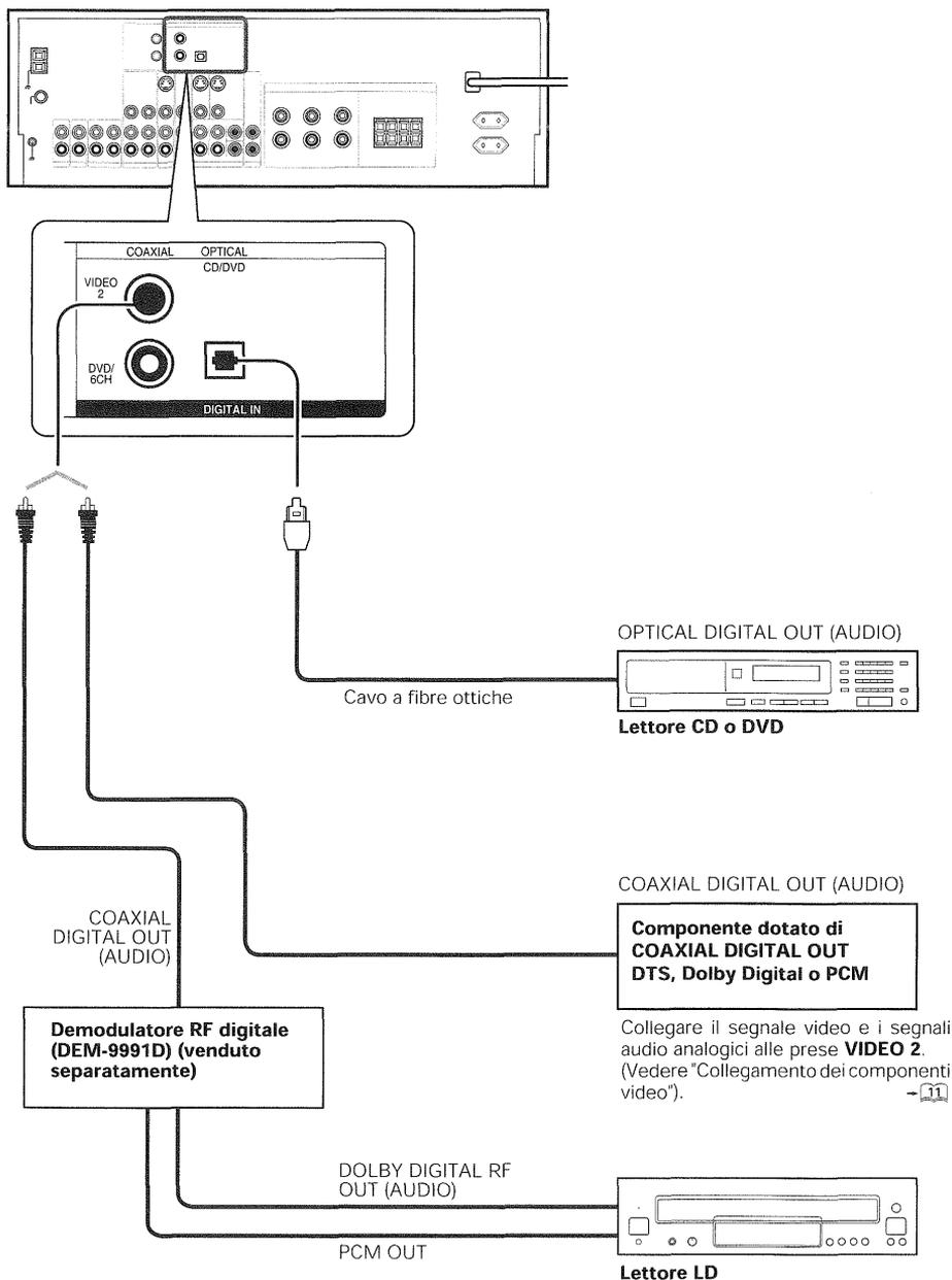
Per collegare un lettore LD a DIGITAL RF OUT, collegare il lettore LD al demodulatore RF digitale (DEM-9991D) di KENWOOD. Collegare quindi le prese DIGITAL OUT del demodulatore alle prese DIGITAL IN del ricevitore. Collegare il segnale video e i segnali audio analogici alle prese VIDEO 2. (Vedere "Collegamento dei componenti video".)
