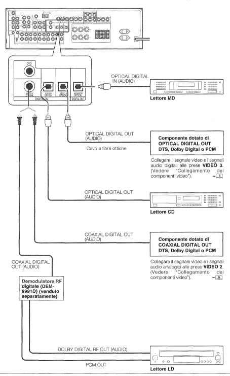
Per collegare un lettore LD a DIGITAL RF OUT, collegare il lettore LD al demodulatore RF digitale (DEM-9991D) di KENWOOD. Collegare quindi le prese DIGITAL OUT del demodulatore alle prese DIGITAL IN del ricevitore. Collegare il cavo del segnale video e i cavi dei segnali audio analogici alle prese VIDEO2 o VIDEO3. (Vedere "Collegamento dei componenti video".)
