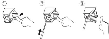
Per l'antenna FM: regolare la posizione dell'antenna FM in modo da ottenere la migliore ricezione, quindi fissarla.
