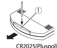
**2 Die alte Batterie durch dieneue ersetzen.**
