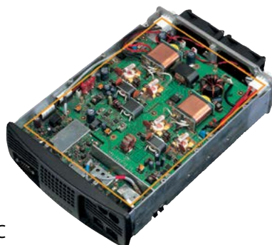
Potenza RF da 200 W (50 MHz: 100 W), funzionamento a 13,8 V CC
