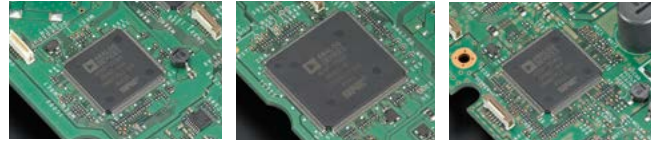
Per la IF principale DSP, unità di trasmissione ADSP-21363 clock @333 MHz
